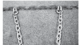
「ねじれ」が取れた正常な状態
