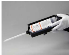
レバー②を押しながらピストンロッド①を完全に引き、カートリッジをセットします。(部位は、右下「専用ガン」写真参照。)
