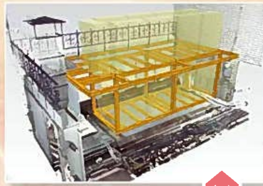
点群データ上の新規の構造部材
