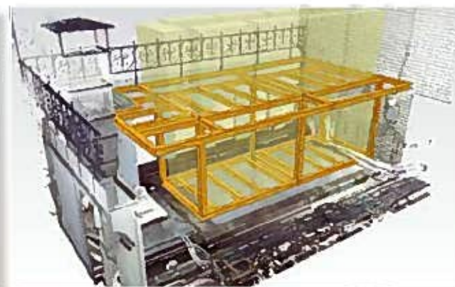
新設機器のCADデータ作成
