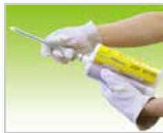
カートリッジの吐出口に、ミキシングノズルを締め込みます。装着は使用直前に行ってください。
