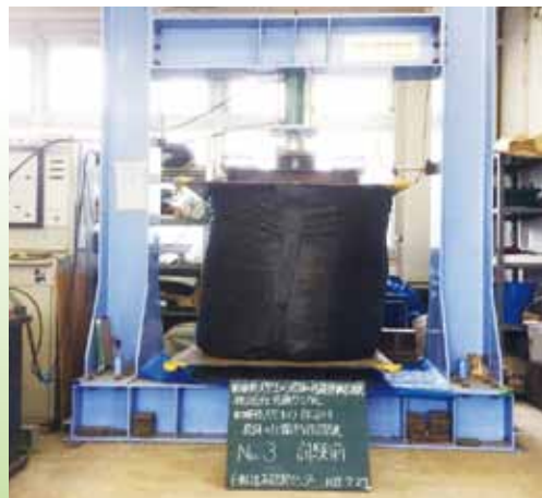
圧縮耐力試験
