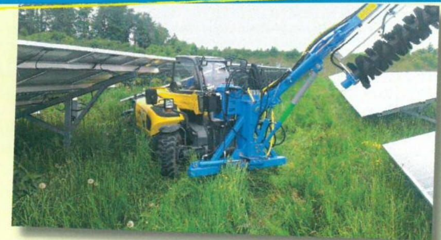
四輪操舵車に取り付けると、狭い ソーラー発電所でも簡単に清掃可能
