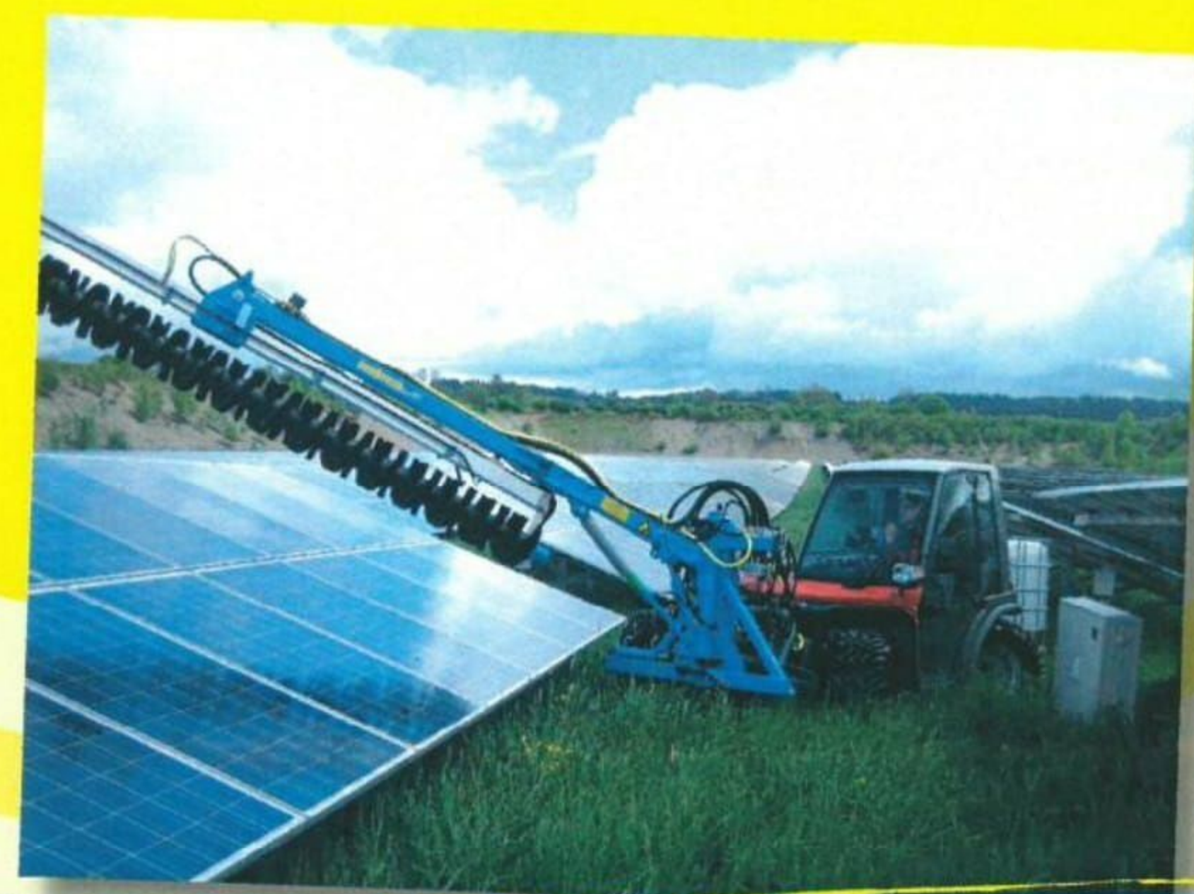
四輪操舵車に取り付けると、狭い ソーラー発電所でも簡単に清掃可能
