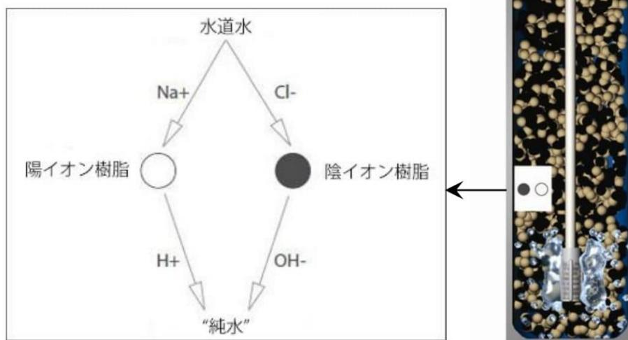
QLEEN に内蔵されたタンク内の、特殊加工されたボール状の陽イオン樹脂・陰イオン樹脂により、流入した水道水をタンク内で “純水” に変化させて放水します。
