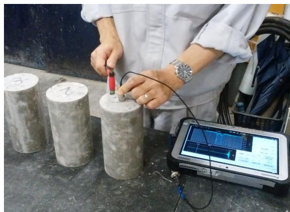
円柱供試体の弾性波速度測定状況
