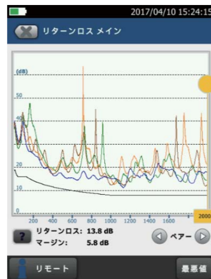
DSX-8000 Cat 8 リターン・ロス測定例
