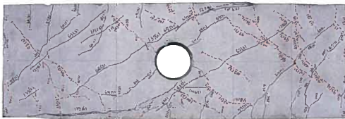
5N-24 (KSS:S8) Q_{max}=342\text{kN}
