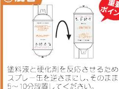
塗料液と硬化剤を反応させるためスプレー缶を逆さまにし、そのまま5~10分放置してください。
