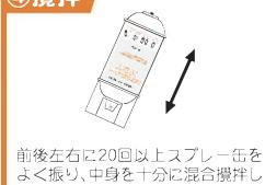
前後左右に20回以上スプレー缶をよく振り、中身を十分に混合攪拌してください。
